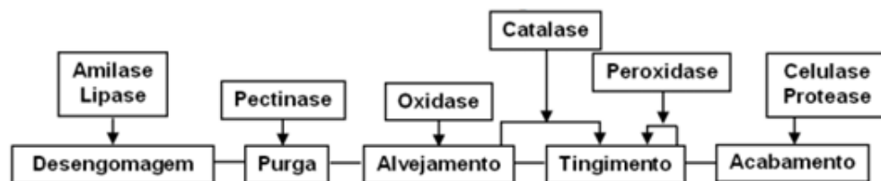
Figura 10: Fluxograma com as etapas do processo têxtil onde as enzimas podem ser utilizadas
