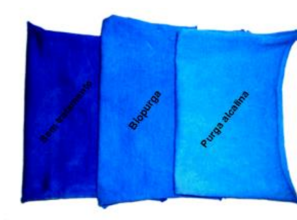
Figura 12: Amostras de tecidos tingidas com azul de metileno para verificação da remoção de pectina
